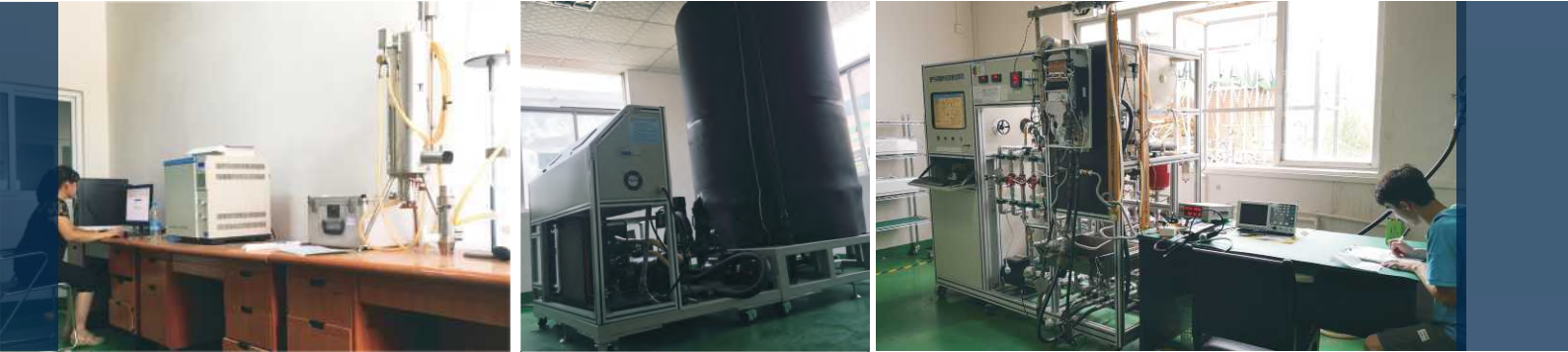
智能全自动综合测试系统 + 可同时满足燃气采暖热水炉和燃气热水器的测试 + 手动综合测试系统：比对实验，确保实验数据无误 + 高精度日本品川燃气流量计
